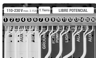
AUX 1 3 y 4 Base (bomba)* o Ultravioleta (según modelo) AUX 3 13 y 14 Control calefacción 15 y 16 AUX 2 5 y 6 redox / Cloro Libre ppm's (bomba)
